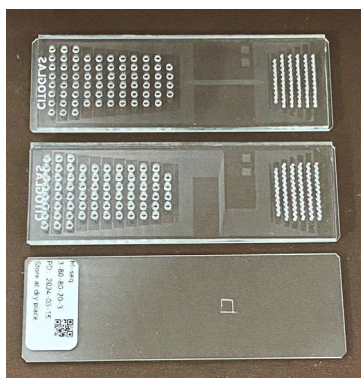
微流控孔道(10 μm分辨率)
