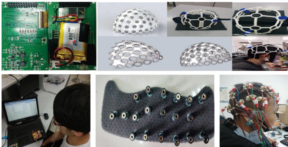
48 通道近红外光谱脑电 EEG/18 通道近红外光谱头盔
