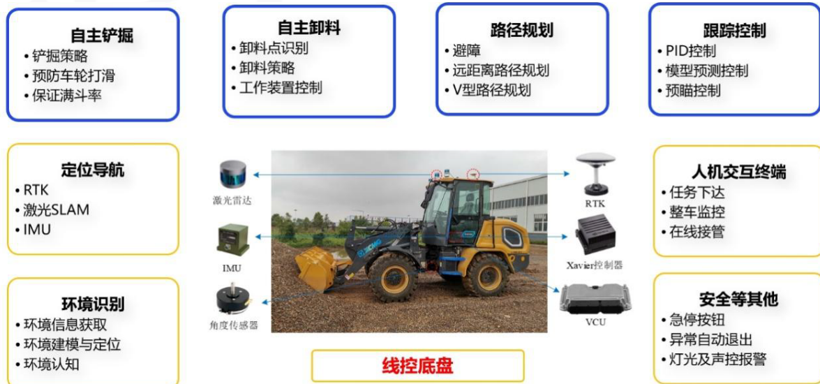
工程机械自主作业系统功能模块
