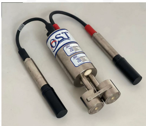
南极冰下湖湖水随钻多参数传感阵列
