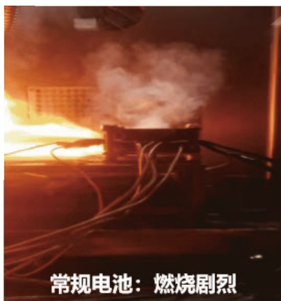
图 2 NCM811/ 石墨常规电池与热免疫电池热滥用测试结果
