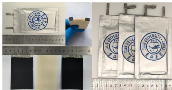
图 2 a) 袋式超级电容器产品及其结构部件的照片； b) 三个单独的袋式超级电容器串联构成超级电容器组的产品照片
