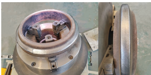
图 3 等离子熔覆加工盾构机部件
