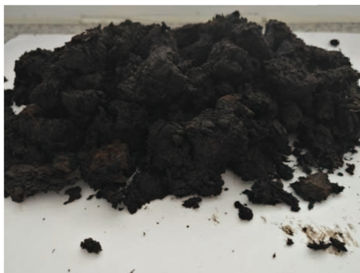
近临界水快速液化农业废弃物固体产物
