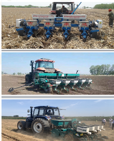
超大宽幅、电驱高速玉米精播机
