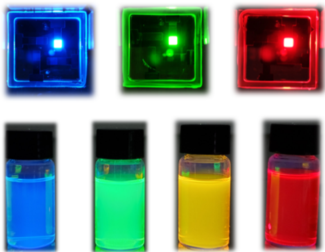
窄光谱材料小试样品在溶液中的荧光照片及电致发光器件照片
